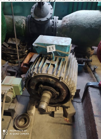
13 Двигатель 5AMP250S2 900/3000/лапы
