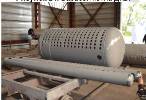
Рисунок 24. Барабан котла ДКВР
